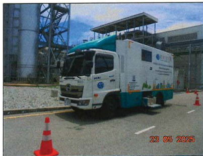
ภาพที่ 3 แสดงการตรวจวัดเพื่อทดสอบความแม่นยำสัมพัทธ์ ระบบ CEMS สำหรับตรวจวัดก๊าซ ของบริเวณ ปล่องหน่วยผลิตไอน้ำ (HRSG) #12
