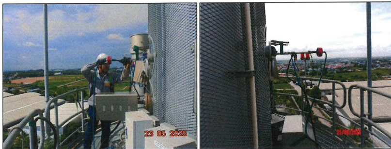
ภาพที่ 4 แสดงการตรวจวัด RM Method ของบริเวณ ปล่องหน่วยผลิตไอน้ำ (HRSG) #12
