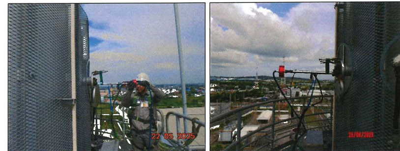
ภาพที่ 2 แสดงการตรวจวัด RM Method ของบริเวณ ปล่องหน่วยผลิตไอน้ำ (HRSG) #11
